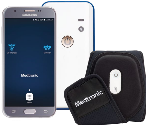
Abb.7 Hand- und Kommunikationsgerät für die Neurostimulatoren. Ladegürtel und -gerät für den wiederaufladbaren Stimulator.
