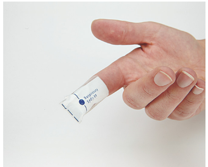
図5 Nellcor レスピラトリーセンサの右人差し指への装着。 SpO 2 はもちろんであるが、呼吸回数を測定することが可能
