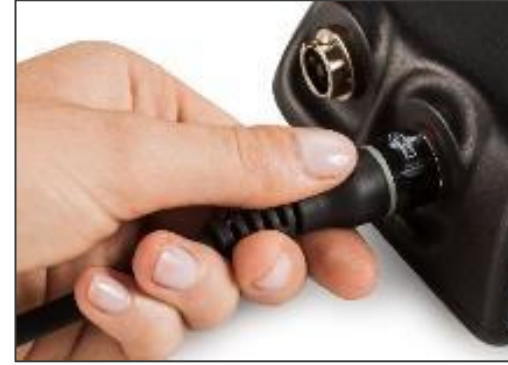
3. コネクタをねじらないようにして、まっすぐに押しこみます。
