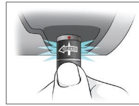
4. ロック位置に合うよう白矢印が少し移動し所定の位置でコネクタが自然にロックされます。コネクタに近い部分を軽く引っ張り、正しく固定されているか確認してください。
