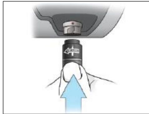
2. コネクタ上の白矢印をコントローラの点にそろえます。
